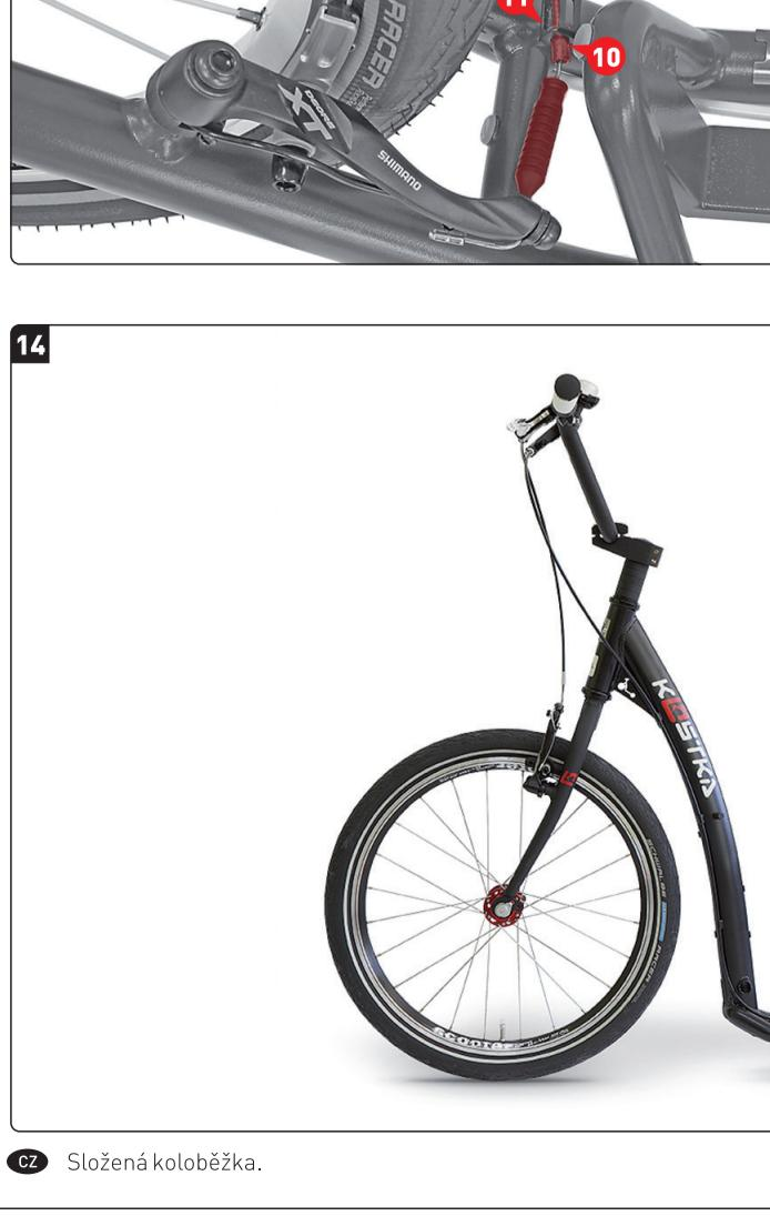
**CZ** Spojíme přední brzdu. Nasadíme vodítka lanka **4** zpět do pozice **5**. Pro kontrolu roztočíme kolo, které se musí volně otáčet. Po zmačknutí přední brzdové páky se musí zastavit.
